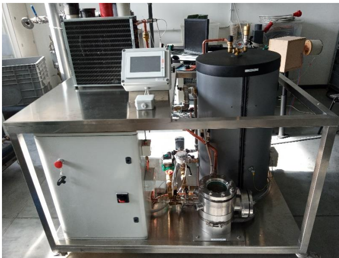
Fig. 13 : Boiling test rig
